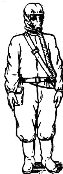
Рис.41 Комплект защитной фильтрующей одежды
