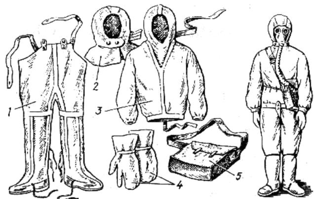
**Рис.37** Легкий защитный костюм Л-1: 1 — брюки с чулками; 2 — подшлемник; 3 — рубаха с капюшоном; 4 — дупалые перчатки; 5 — сумка для хранения костюма. Справа — защитный костюм в «боевом» положении
