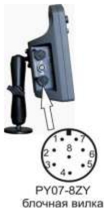
схема подключения НК к кнопке управления буром почвоотборника
