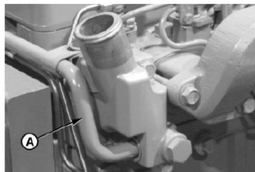
А - Патрубок между крышкой термостата и водяным насосом
