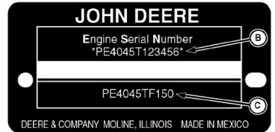
Табличка с серийным номером двигателя, изготовленного в г. Тореон
