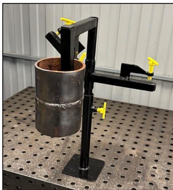
Рис.1 Универсальный позиционер для отработки навыков сварки в различных пространственных положениях
