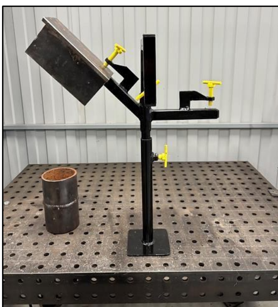
Рис.1 Универсальный позиционер для отработки навыков сварки в различных пространственных положениях
